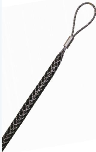
Предназначен для временного захвата кабеля с торца при проведении работ по прокладке кабеля в траншеях, колодцах, трубах кабельной канализации. Однородное распределение нагрузки по всей площади захвата кабельного чулка препятствует повреждению изоляции кабеля и сползанию кабельного чулка в процессе протяжки. Изготовлен из стального оцинкованного троса высокой износостойкости.
